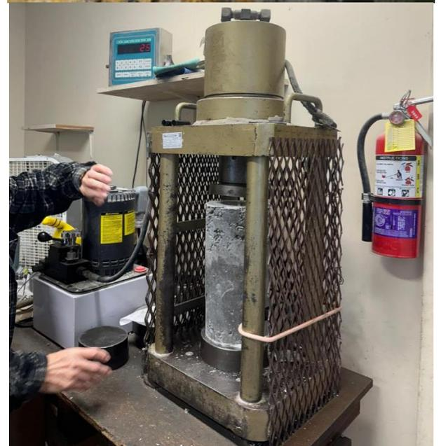
Figura 13: Resistencia a la Compresión del CRF
