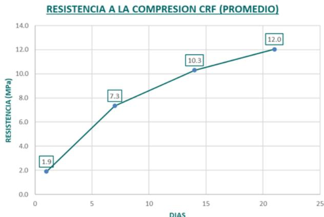
El diseño del método indica que para realizar el minado inferior y exposición del CRF se requiere como mínimo 5MPa a los 21 días. Durante la aplicación a nivel industrial se consiguió 12MPa a los 21 días, lo que significada que el CRF cumplía por encima la resistencia requerida para iniciar el minado.
